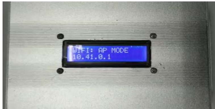
Gambar 5. Tampilan LCD saat menampilkan alamat IP Raspberry Pi 4
