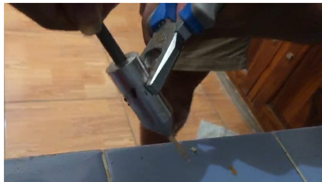
Gambar 5. Pendorongan Material dari Cetakan
