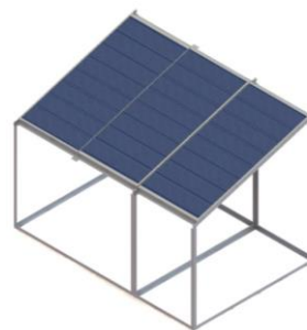
Gambar 2. Kerangka Panel Surya Sistem DC
